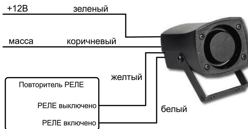
Схема 2: Подключение к Повторителю реле
